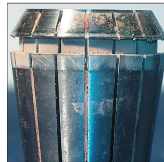
Stark verschmutzte Spannzange
